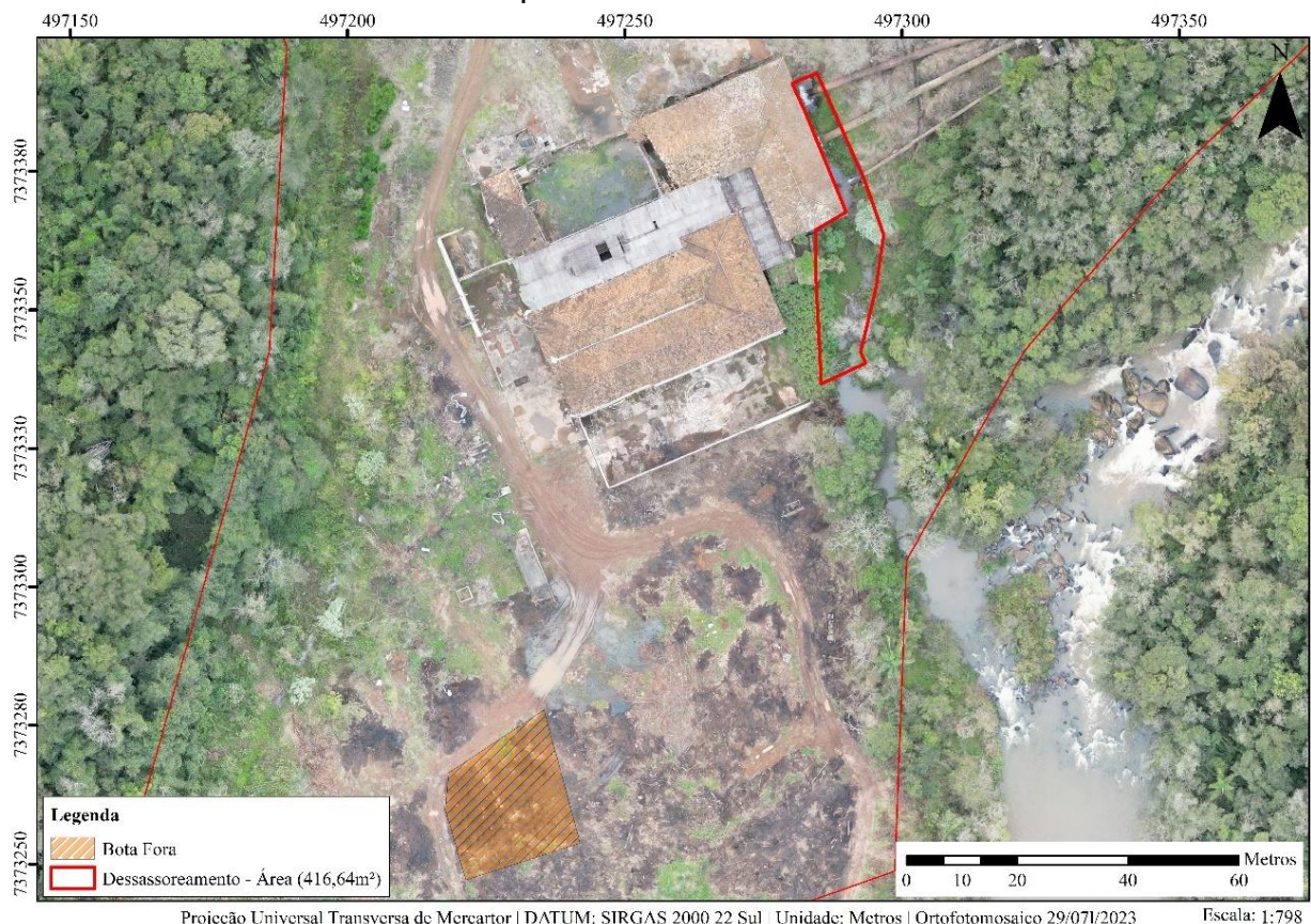
Figura 38 - Croqui com esquema de escavação da bacia de deposição do material e bota fora do proveniente do dessassoreamento.
