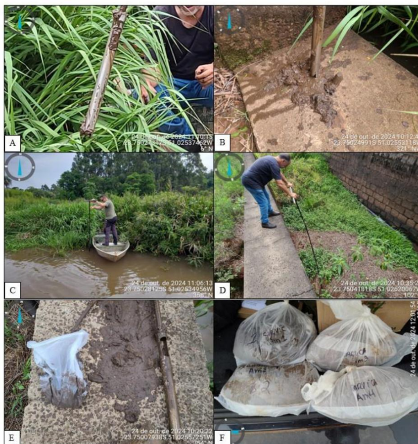
Figura 7: Amostragem com trado de caneco nas áreas 1 e 2. Amostras foram coletadas, identificadas e enviadas para laboratório.
